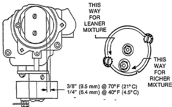
FIGURE 19. ELECTRIC CHOKE
