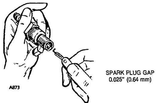
FIGURE 27. SPARK PLUG GAP
