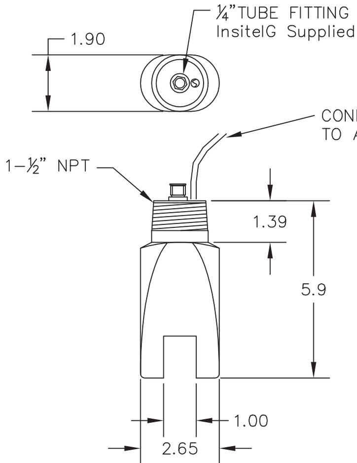
CONNECTION CABLE TO ANALYZER
